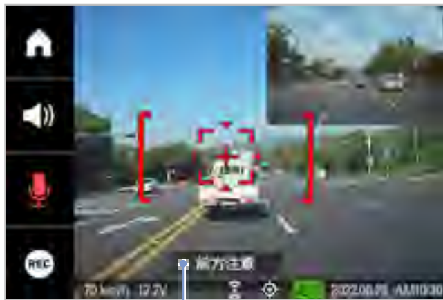
2次前方衝突警告 ：前方衝突の危険を検知した後、前方車両との間隔がさらに縮まった際に表示されます。
